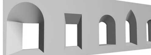
Arriba: Ventanas tipo abocinadas y abajo ventana tipo sisa. Fotografía No. 1.6.9 F2-F3
