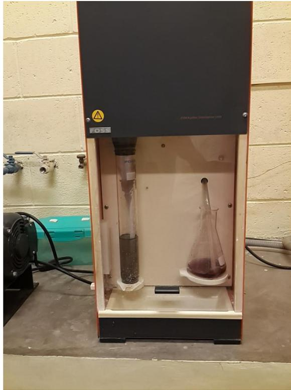
**Figura 7A.** Muestras en Micro Kjendhal para determinacion de proteína cruda.
