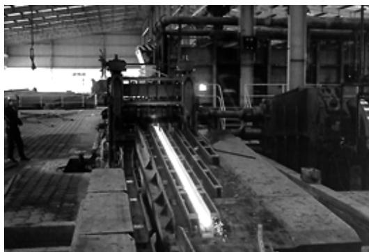
*Figura 1.* Proceso de laminación.
