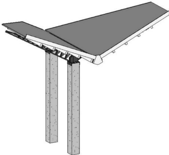
Imagen No. 76 Detalle de canal en borde de techo Fuente: Elaboración Propia Colocación de canal para bajada de agua pluvial en el borde de los techos, esto para que no afecte al usuario en momentos de lluvia, y así se dirige el agua a las bajadas existentes.
