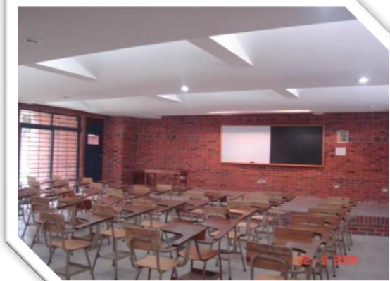
Todas las aulas cuentan con ventanas hacia exterior. Se aprovecha la luz natural con ventanas amplias y el mobiliario dispuesto de manera que la luz no interfiera con la visual de los alumnos.
