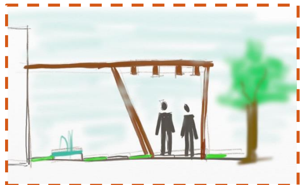
Figura 98. El caminamiento peatonal deberá estar techado debido a la fuerte incidencia solar (Orientación SW).
