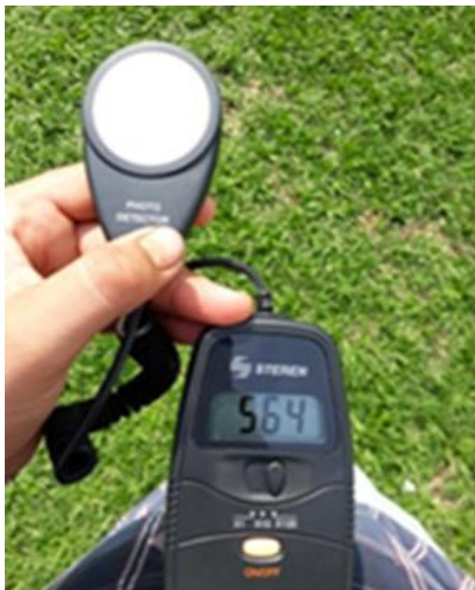
**Figura 27. Luxómetro utilizado para la toma de datos durante la evaluación.**
