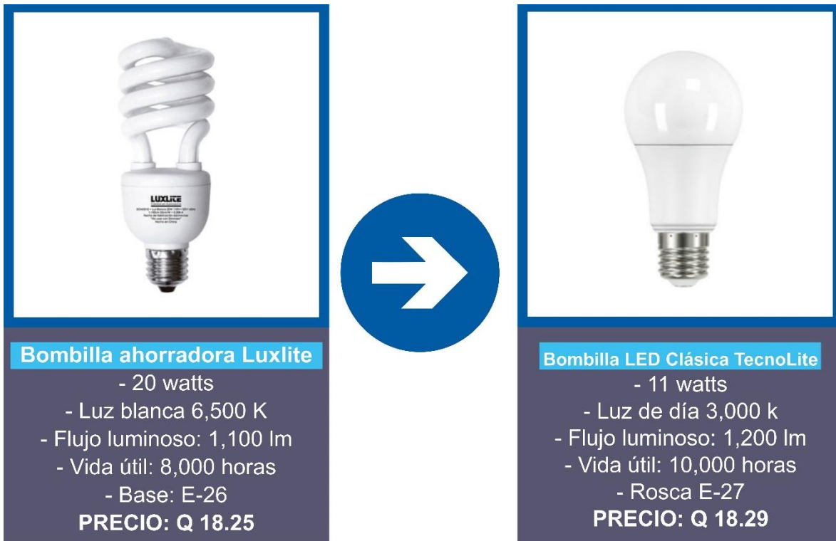
Figura No. 4 Características bombilla ahorradora a bombillas LED
