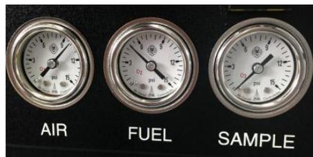
2. Verificar y/o ajustar el flujo de la muestra mediante el Sample Bypass; la lectura debe ser 1.0.
