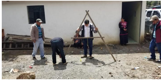
Figura 4. Explicación sobre la creación de curvas a nivel Fuente: autor 2019
