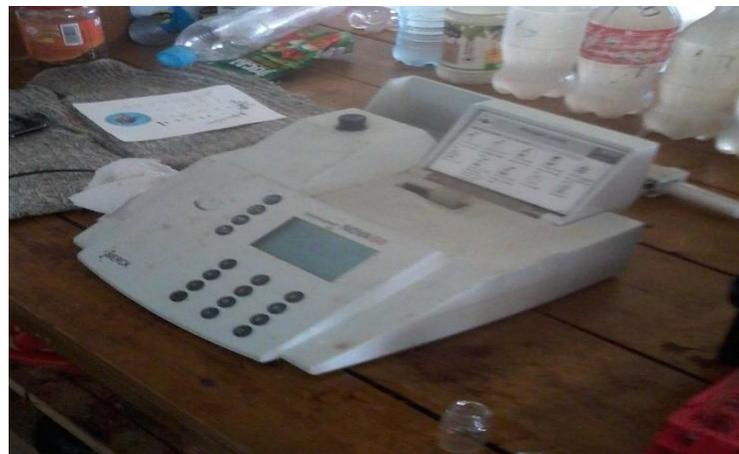
**Fotografía 3A.** Espectrofotómetro Merck Nova 60.
