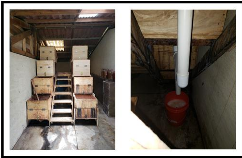
Figura 4 Cajones de fermentación instalados y funcionando para la recolección del exudado del cacao.
