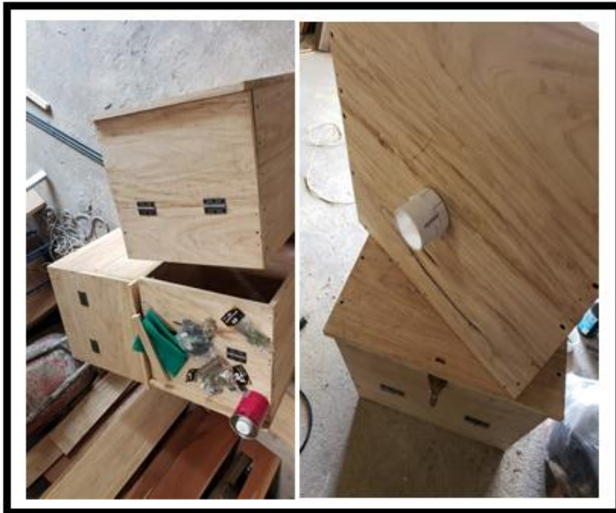
Figura 3 Fermentadores con adaptación para la recolección del exudado de las semillas del cacao.
