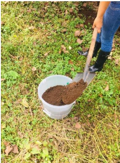
**Figura 5. Homogenización de sub-muestras.**
