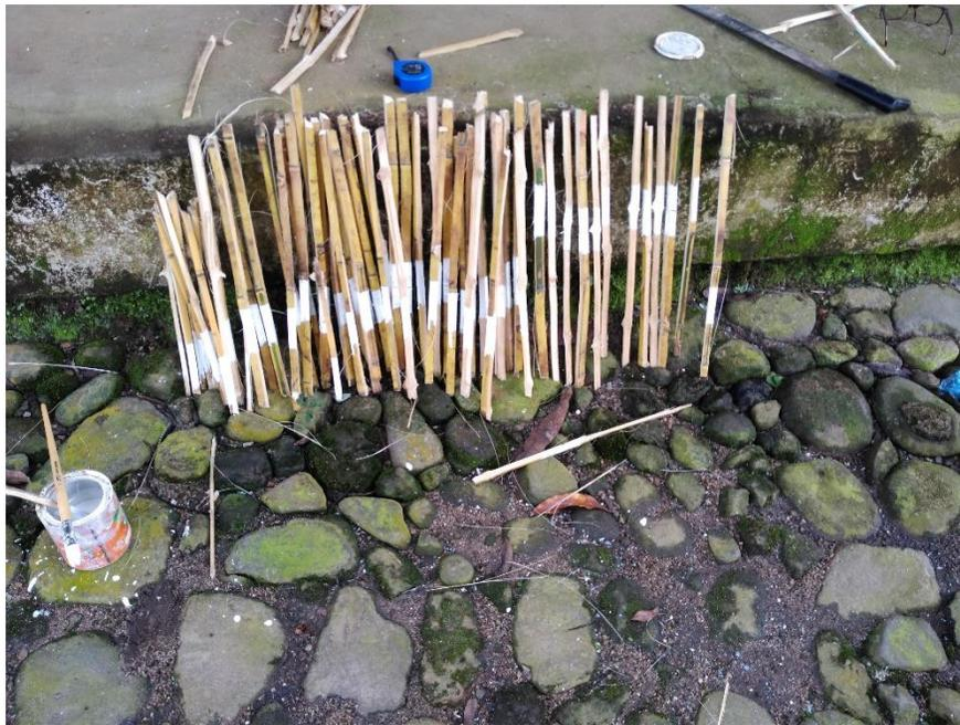
Figura 12 Fabricación de varitas para medir la erosión.
