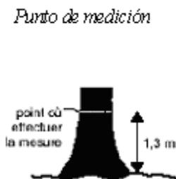
Figura 5. Posición para la medición del diámetro normal (a la altura del pecho) en terreno llano
