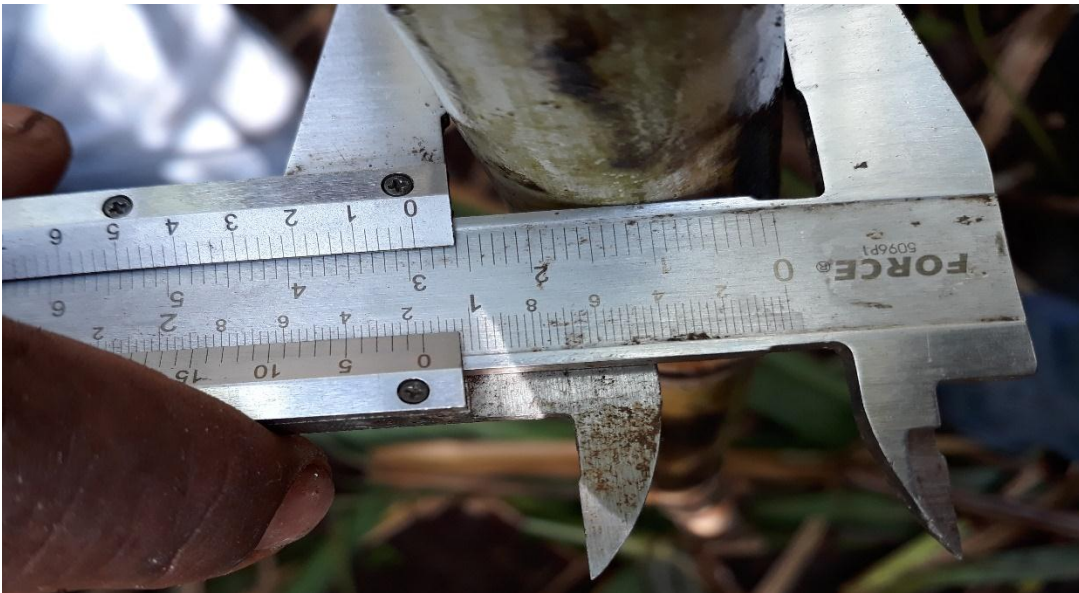
Figura 21. Medición de diámetro con vernier en el ensayo de subsolado.
