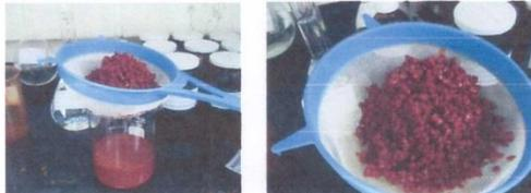
Figura No.4. Precipitación del colorante de achiote agregando ácido sulfúrico al 10% m/v y filtración al vacío.
