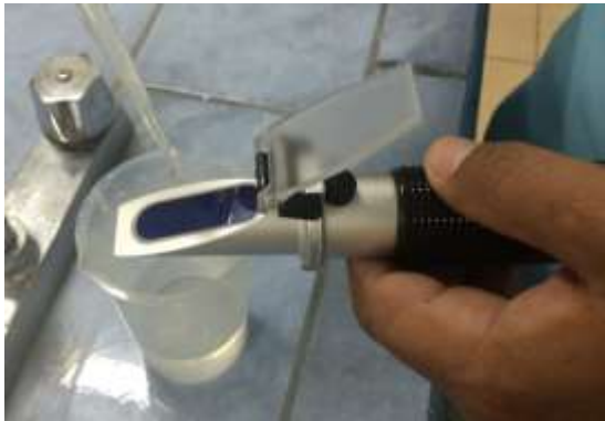
Figura 16. Colocación de la muestra en el refractómetro.
