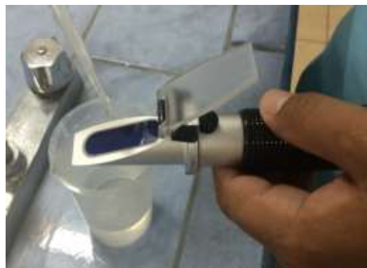
Figura 6. Carga de la muestra en la cámara del refractómetro clínico manual.
