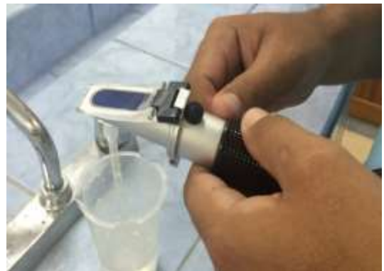
Figura 17. Distribución uniforme de la muestra sobre el prisma,
