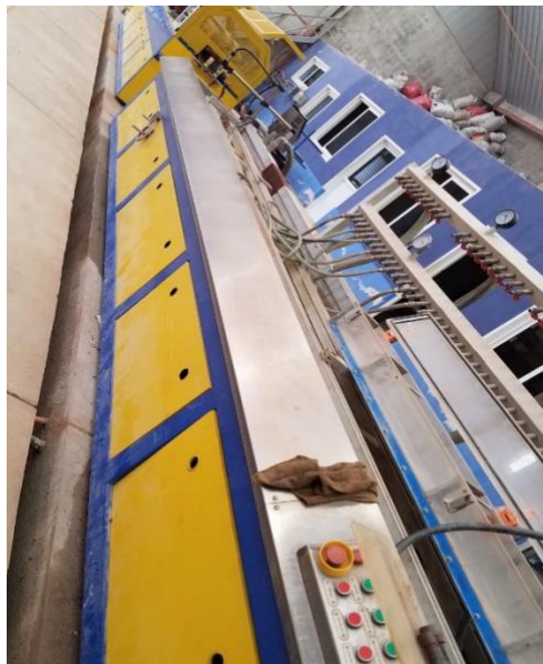
Imagen 6. Tren formador de extrusora
