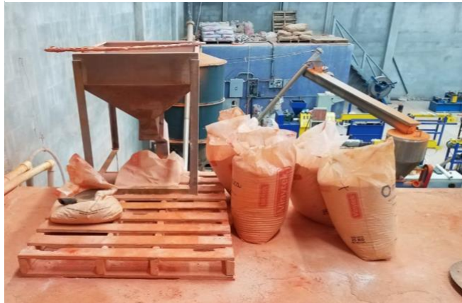
Imagen 1. Tolva de alimentación y mezcla
