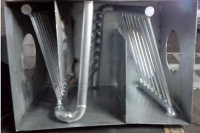
Una fotografía que muestra una vista lateral (perfil) de las bobinas de serpentín del economizador. Se observan varias bobinas de metal con un tubo central que se curva en forma de U.                                                         |
