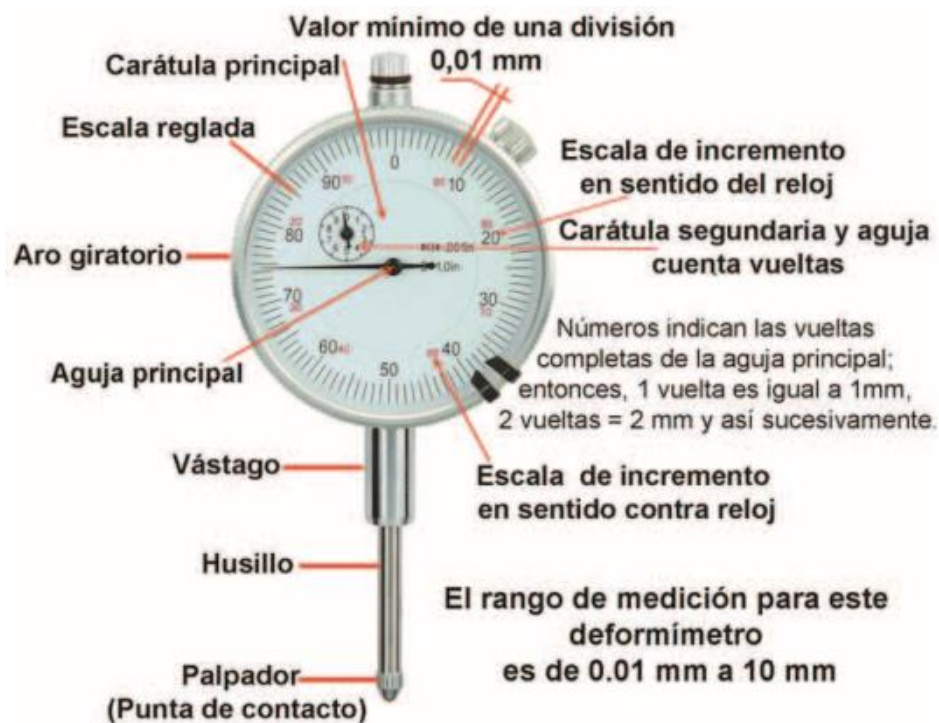
Figura 2. Partes de un deformómetro
