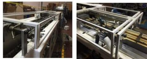
5. Se realizó la instalación de los ensambles divisores de envases.
