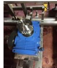
4. Se llevo a cabo la instalación del tensor correspondiente a la cadena de embudos luego de su limpieza completa.
