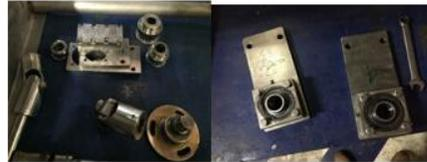
3. Luego de una inspección en las poleas correspondientes a la faja de potencia de la cadena de embudos, se halló una serie de defectos que producen cortes en esta, por lo cual se procederá a su cambio.
