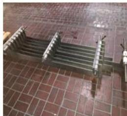
2. Así también se realizó el desmontaje del mecanismo de potencia del transportador, el cual presenta una cadena con suciedad acumulada al igual que las chumaceras.
