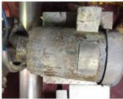
4. Se procedió al desmontaje del tornillo alineador de envase, para el cambio de sus cojinetes, debido a su condición es posible el reemplazo de ~~este~~, también (4 Retenedores 471255, 4 Cojinetes KOYO EE557 o 6310).
