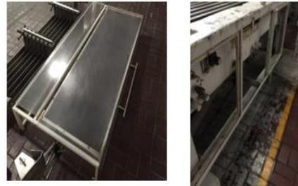
3. El proceso continuo con el desmontaje de las fajas del transportador de entrada y las gomas de deslizamiento inferior, revelando que el equipo se encuentra altamente deteriorado.
