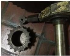
3. Desmontaje de la faja transportadora y guías laterales correspondientes al transportador de corrugado.
