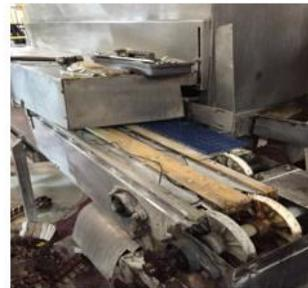
2. Posteriormente se realizó el desmontaje de los paneles de policarbonato tanto superior como inferior para su limpieza respectiva.
