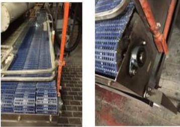
2. Se realizó el montaje de las gomas deslizantes y la cadena formadora de bandeja.
