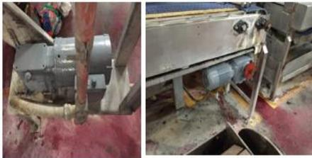
2. Se realizó el montaje de la faja correspondiente al transportador de entrada del equipo.
