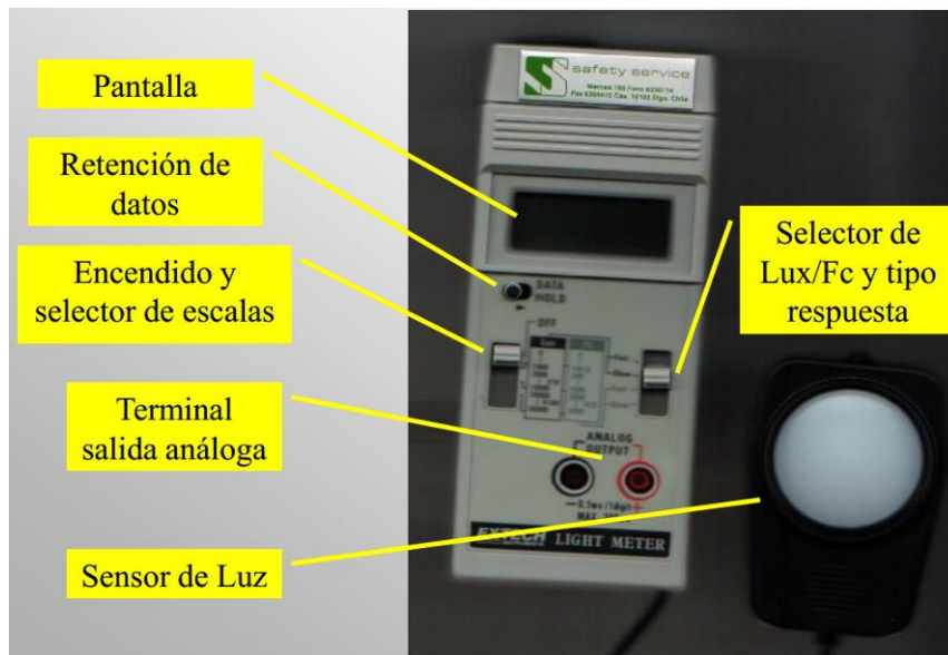
Figura 57. Descripción del panel frontal del luxómetro
