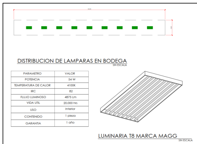
Figura 62. Diseño de colocación de lámparas en cada una de las bodegas
