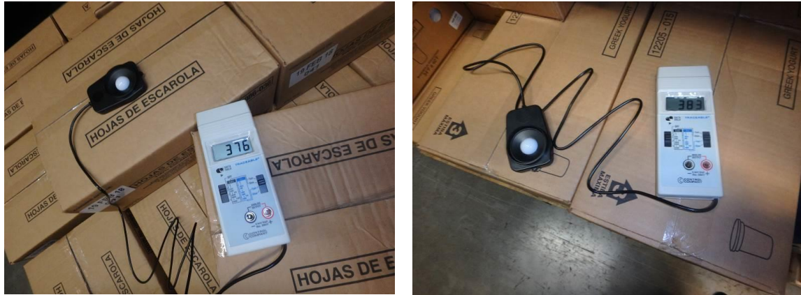
Figura 52. Utilización del luxómetro en la bodega refrigerada
