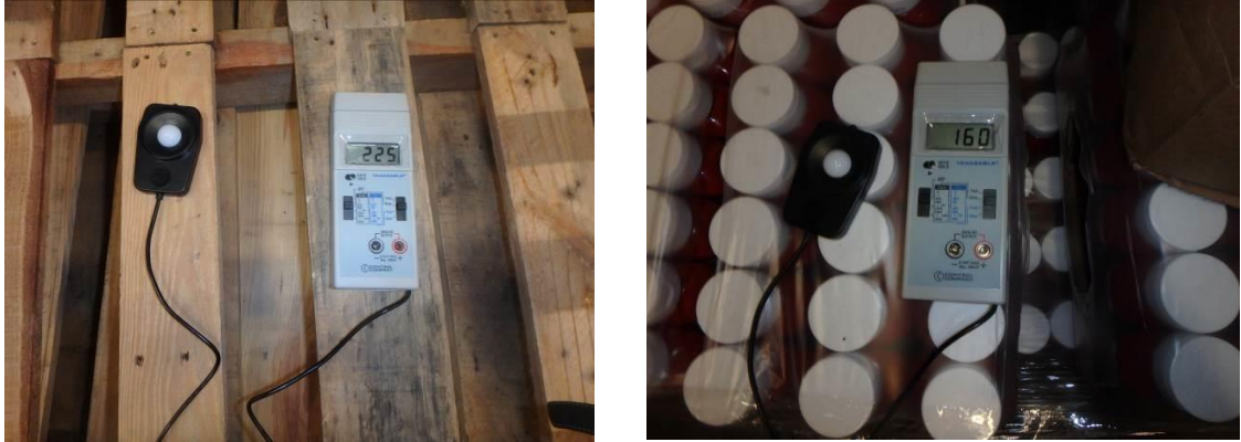
Figura 50. Utilización del luxómetro en la bodega seca
