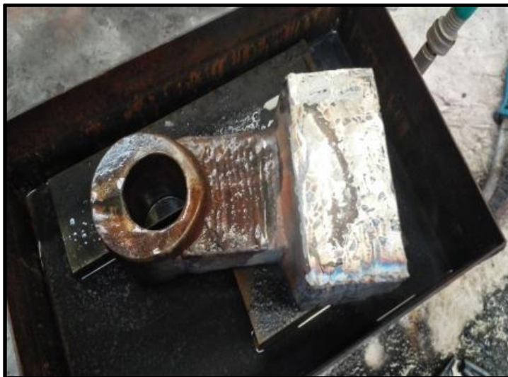
Figura 7. Precaentado de martillo reparado
