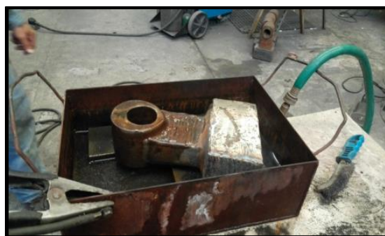
Figura 6. Consideraciones térmicas del martillo reparado
