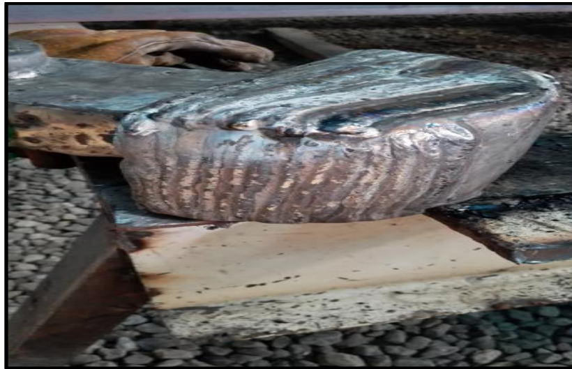
Figura 25. Levantamiento de base para aleación de revestimiento en el martillo
