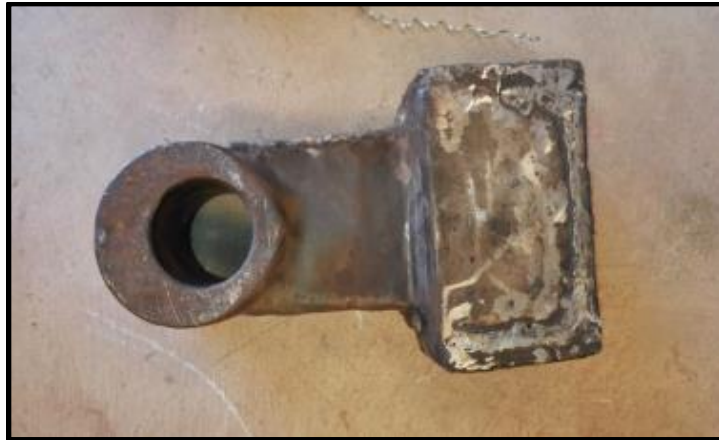
Figura 14. Martillo de molienda reparado
