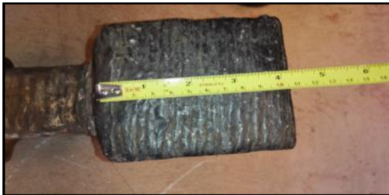
Figura 30. Martillo reparado con acero al manganeso tipo Hatfield
