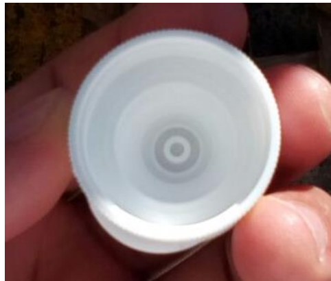
Figura 36. Defecto de tapa sin liner
