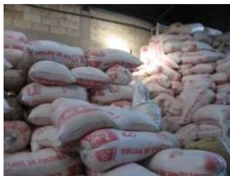
Figura 32. Sacos de concentrado mal estibados
