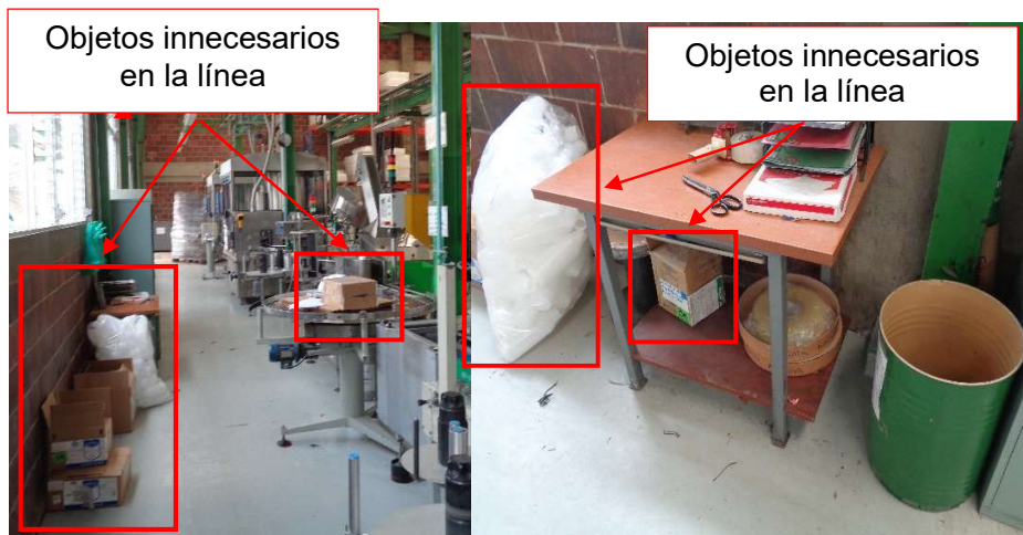
Figura 25. Clasificación en la línea de envasados – área de taponado y etiquetado de envase
