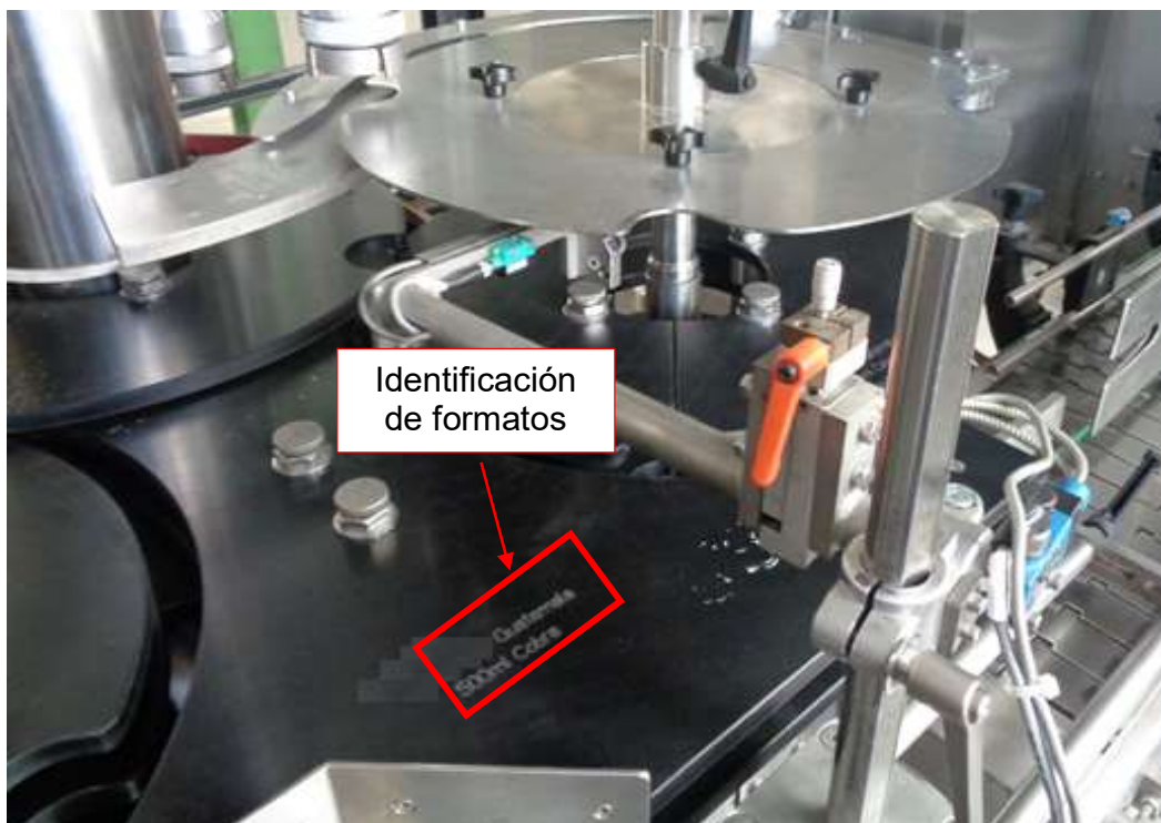
Figura 37. Identificación de formatos para taponadora
