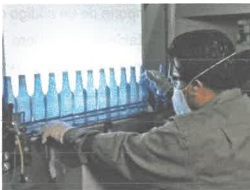
Figura 22. Inspección de botellas
