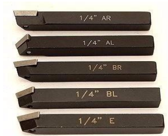
Figura 37. Buriles utilizados en el torno
