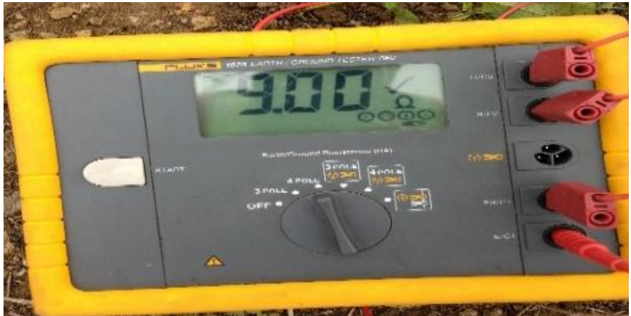
Figura 26. Fotografías tomadas en campo para el cálculo de la resistividad aparente del suelo medición a 3 metros 45 grados
