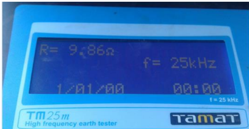
Figura 45. Pantalla del telurómetro resistencia equivalente configuración tipo 1
