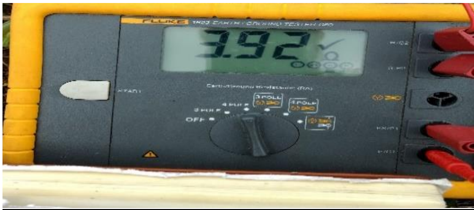
Figura 27. Fotografías tomadas en campo, para el cálculo de la resistividad aparente del suelo medición 4 metros en paralelo
