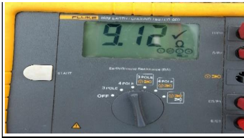
Figura 25. Fotografías tomadas en campo para el cálculo de la resistividad aparente del suelo medición a 3 metros 90 grados
