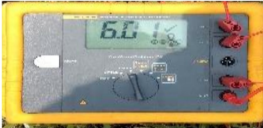
Figura 21. Fotografías tomadas en campo, para el cálculo de la resistividad aparente del suelo medición a 2 metros en paralelo
