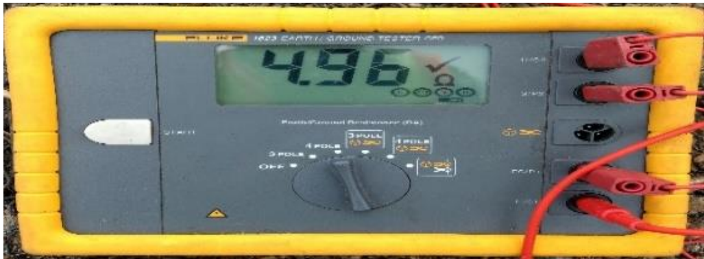
Figura 28. Fotografías tomadas en campo para el cálculo de la resistividad aparente del terreno medición a 4 metros 90 grados
