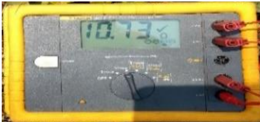
Figura 18. Fotografías tomadas en campo, para el cálculo de la resistividad aparente del suelo medición a 1 metro en paralelo
