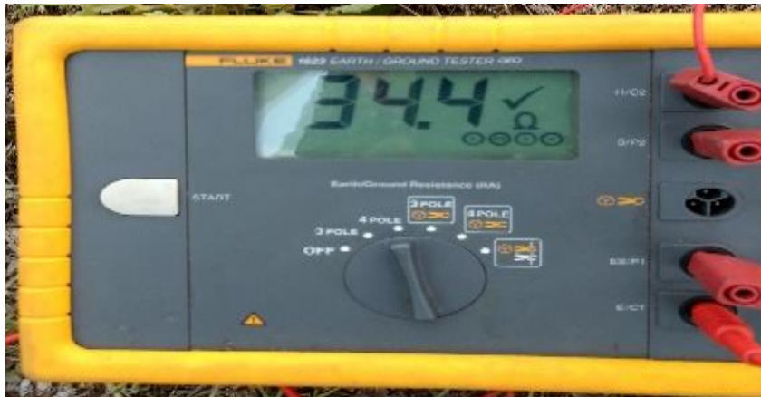
Figura 19. Fotografías tomadas en campo, para el cálculo de la resistividad aparente del suelo medición a 1 metro 90 grados
