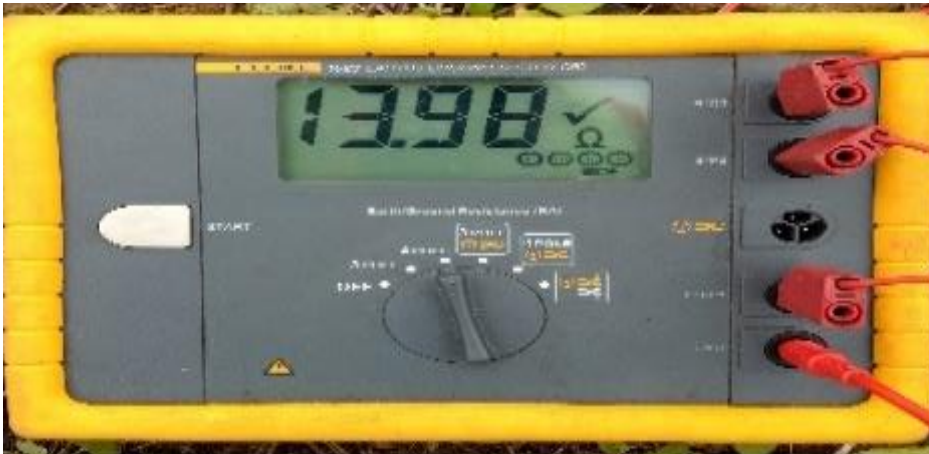
Figura 23. Fotografías tomadas en campo, para el cálculo de la resistividad aparente del suelo medición a 2 metros 45 grados
