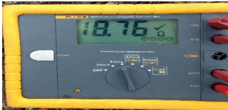
Figura 22. Fotografías tomadas en campo para el cálculo de la resistividad aparente del suelo medición a 2 metros 90 grados
