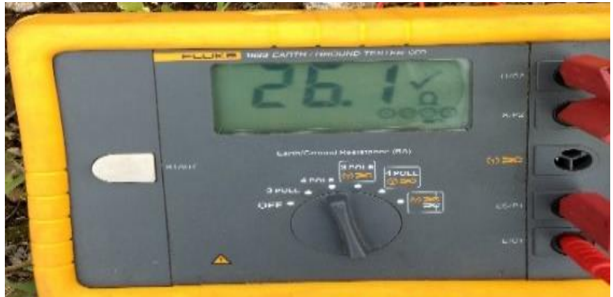
Figura 20. Fotografías tomadas en campo, para el cálculo de la resistividad aparente del suelo medición a 1 metro 45 grados
