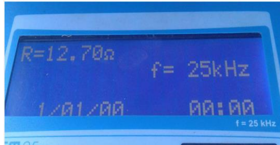
Figura 46. Pantalla del telurómetro resistencia equivalente configuración tipo 2
