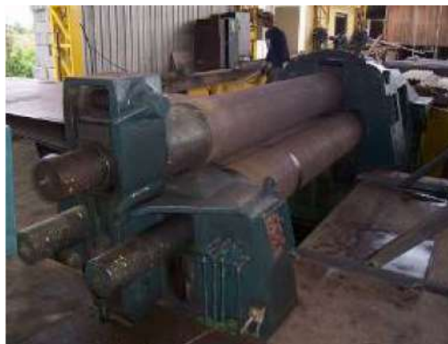
Figura 23. Máquina para rolado de planchas metálicas
