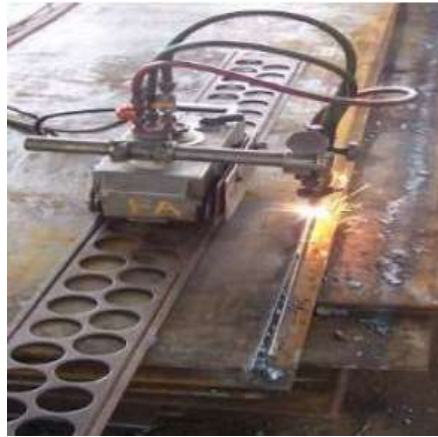
Figura 22. Sistema de corte semiautomático
