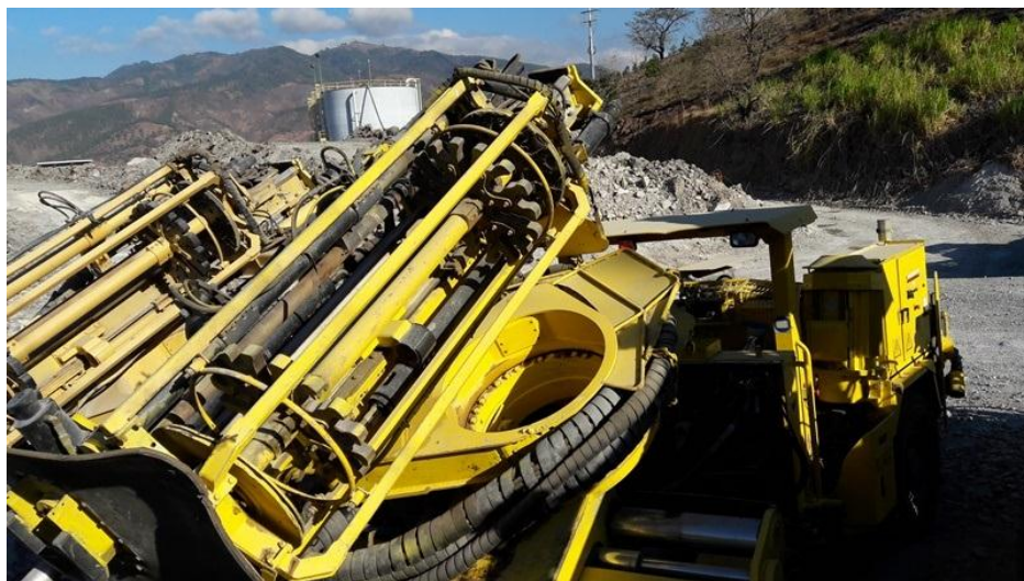
Figura 17. Mesa de avance, brazo manipulador Simba H1354
