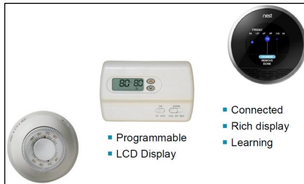
Figura 54. Escala de sistemas embebidos en termostatos
