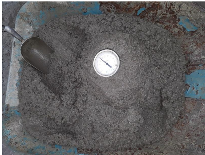
Figura 22. Ensayo de temperatura del concreto
