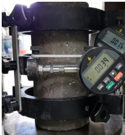
Figura 35. Ensayo módulo elástico del concreto
