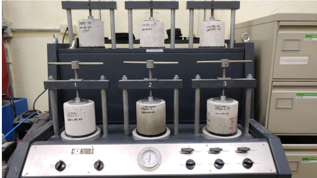
Figura 37. Ensayo de penetración de agua bajo presión
