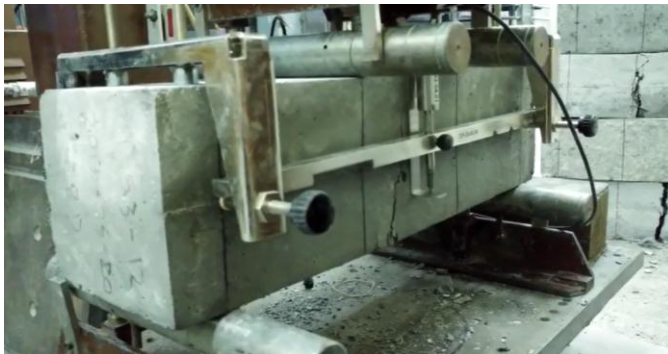
Figura 33. Ensayo a flexión del concreto
