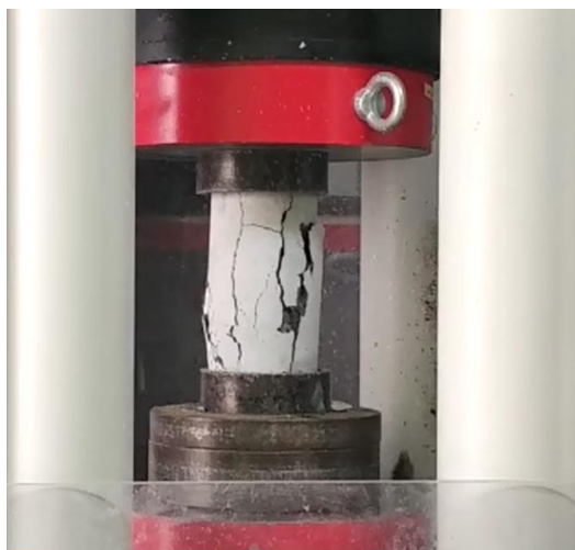
Figura 29. Ensayo a compresión del concreto
