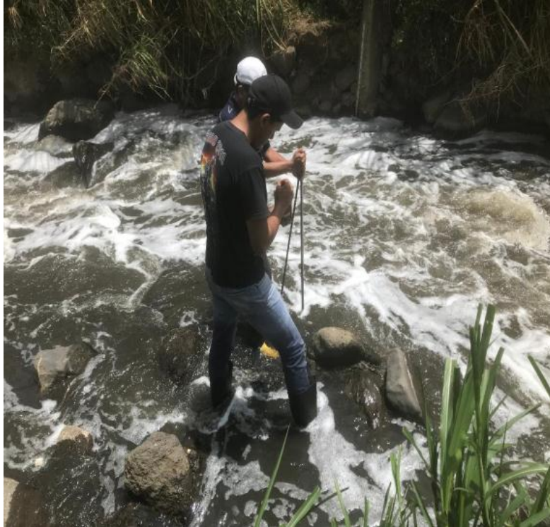
Figura 58. Método por vadeo en Alotenango II
