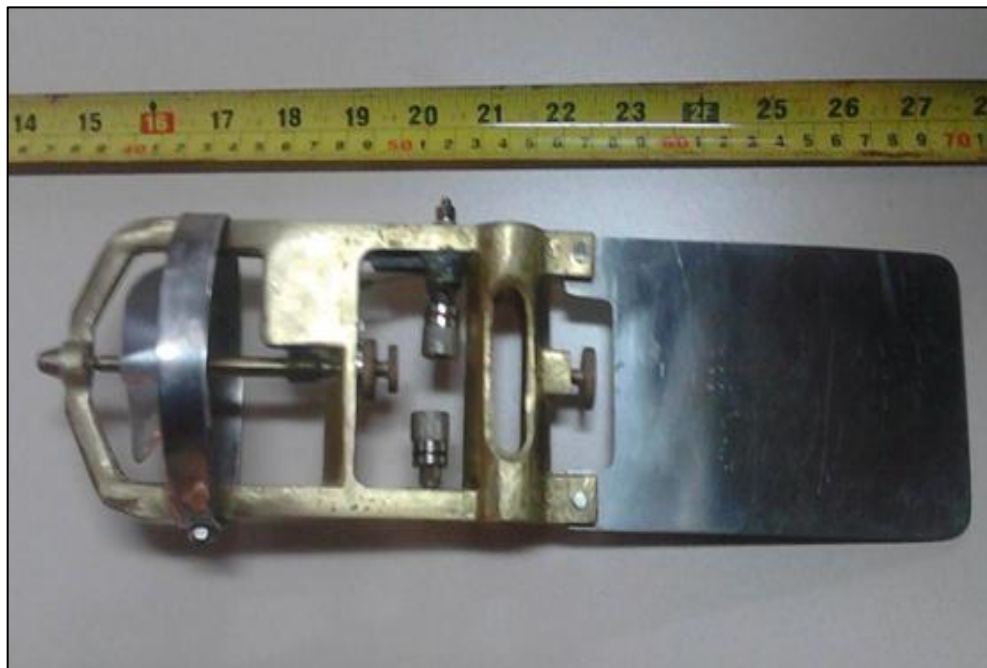
Figura 26. Molinete eje horizontal con hélices de bronce
