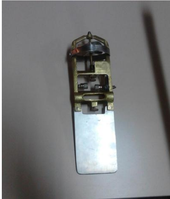
Figura 5. Molinete para calibrar
