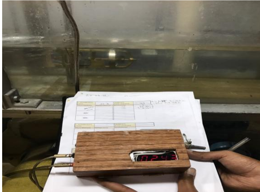
Figura 43. Sistema de conteo de vueltas
