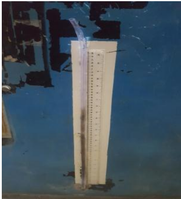
Figura 41. Piezómetro medidor en depósito aforador
