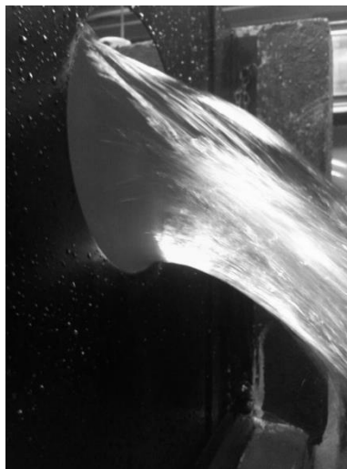
Figura 33. Zona aireada bajo la lámina vertiente
