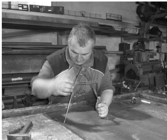
Figura 34. Proceso de trazado y corte de vertedero circular
