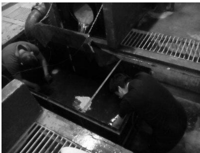
Figura 42. Medición del volumen en el depósito calibrado
