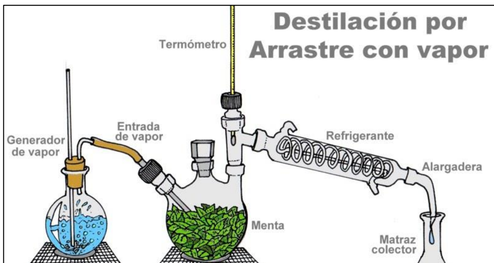
Figura 6. Destilación por arrastre de vapor
