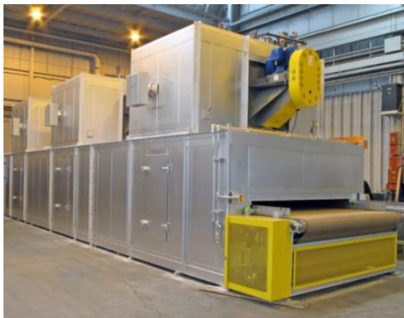
Figura 15. Horno de secado de barniz interior
