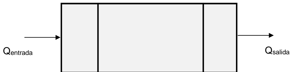
Figura 24. Vista superior de tanque separador de grasa y aceites
