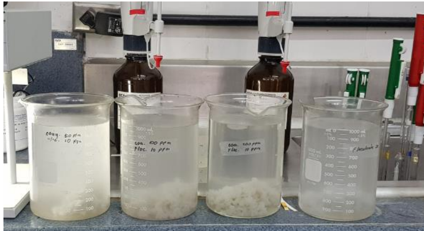
Figura 22. Prueba de sedimentación
