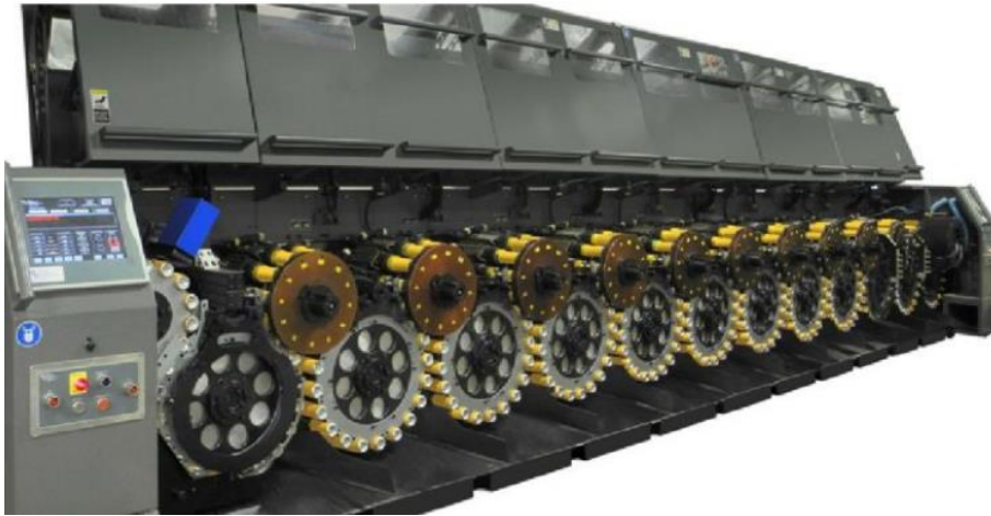
Figura 16. Formadora de cuello y pestaña de envases de aluminio
