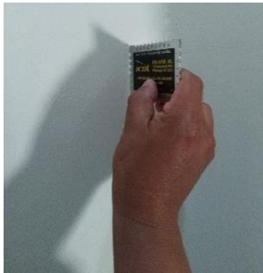
Figura 2. Peine o tarjeta para medir el EPH
