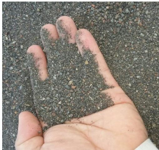
Figura 4. Arena para sand blast
