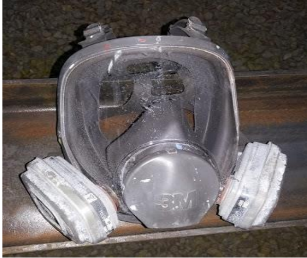
Figura 8. Careta para aplicación de pintura
