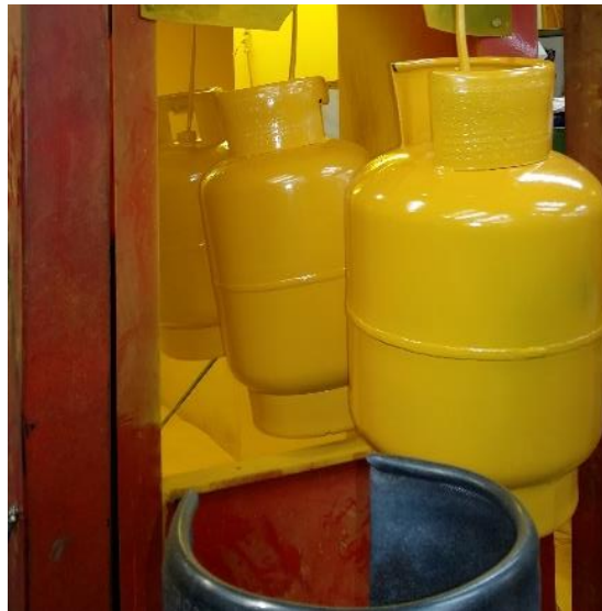
Figura 11. Aplicación de pintura por aspersión con aire
