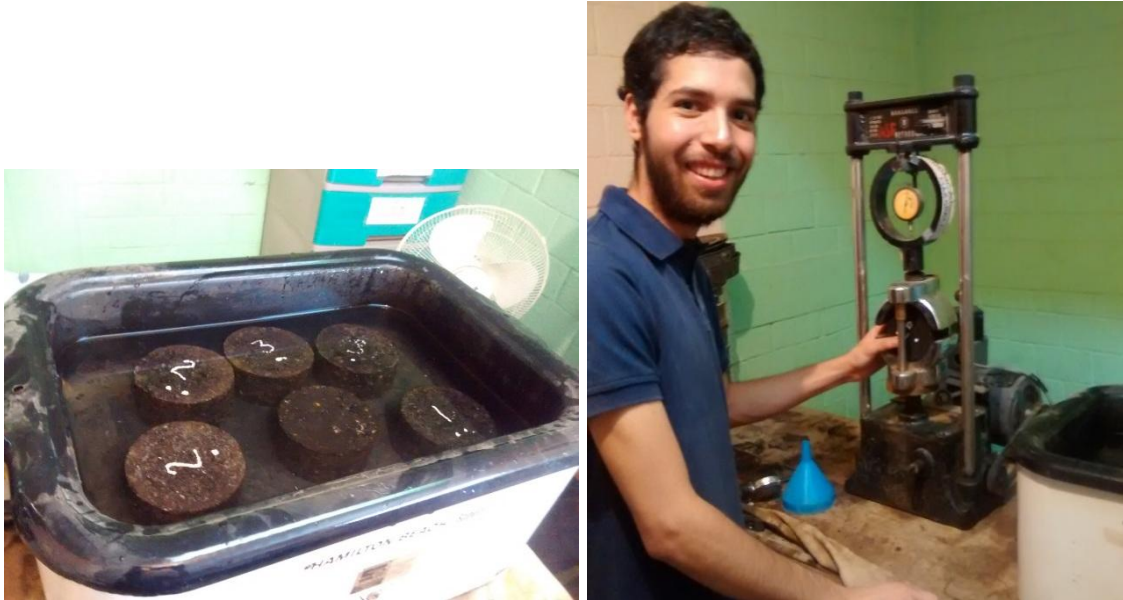
Figura 19. Elaboración ensayo para determinar estabilidad y fluencia
