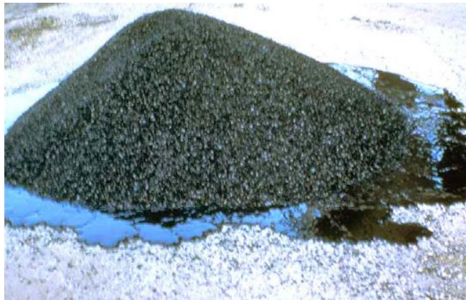
Figura 6. Mezcla asfáltica sin agente estabilizador
