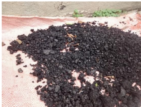
Figura 17. Secado de muestra a temperatura ambiente
