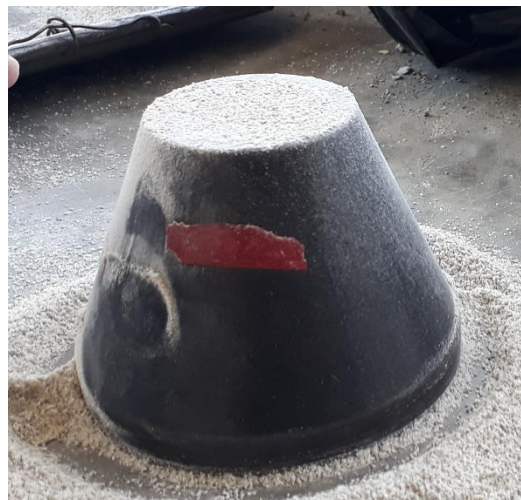
Figura 7. Ensayo de velocidad de endurecimiento por el método de Resistencia a la penetración
