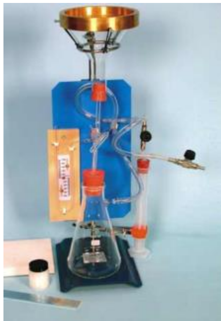
Figura 6. Ensayo de retención de agua
