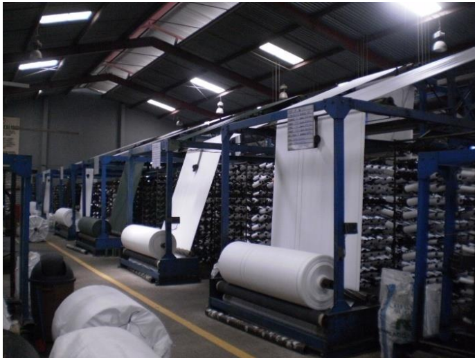
Figura 18. Área de telares tubulares de la empresa
