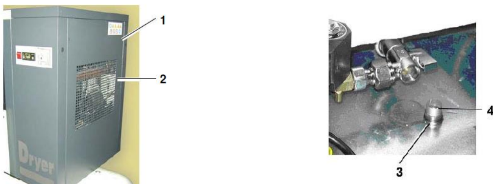
Figura 15. Limpeza del filtro mecánico
