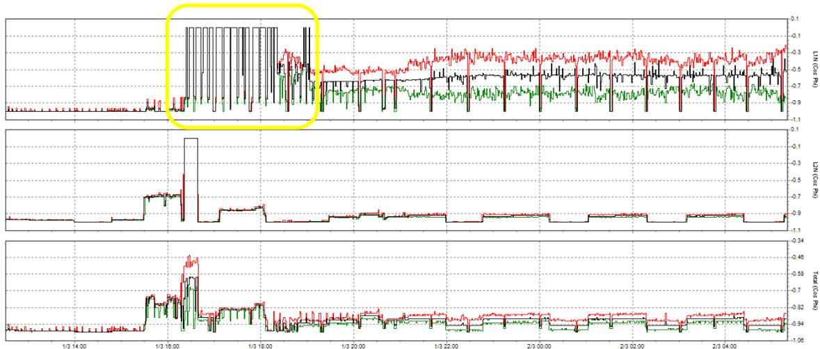
Cabe destacar que en primer gráfico se aprecia una distorsión anormal, esto se dio a causa de una falla de la compañía de distribución.
