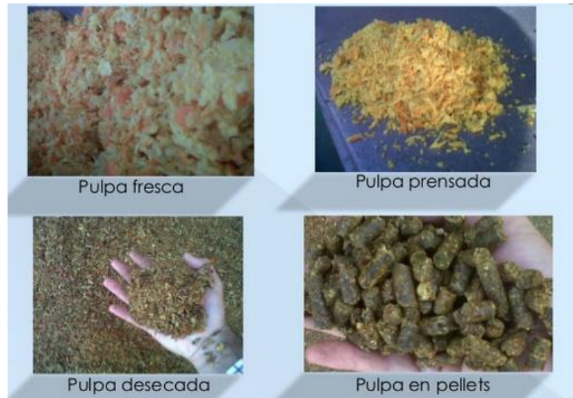
Figura 35. Transformación de los residuos de cítricos en pellets para alimento de ganado bovino
