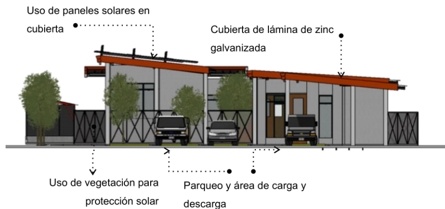
Figura 25. Vista de fachada este de planta de extracción de aceite esencial de mandarina Dancy ( Citrus reticulata Blanco)
