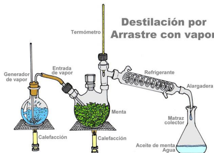
Figura 3. Ejemplificación del proceso de arrastre por vapor directo de un extracto vegetal
