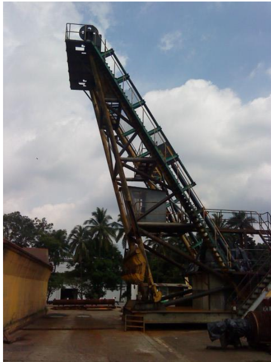
Figura 9. Estructura de una grúa de descarga de caña
