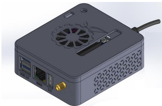
Figura 11. Caja modificada para Orange Pi Pc Plus y NRF24L01
