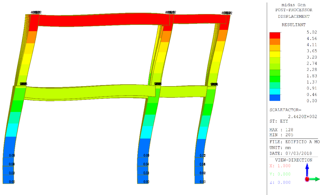
Figura 46. Diagrama incluyendo los efectos del módulo de reacción vertical, módulo 1, eje B
