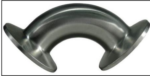
Figura 28. Codo 90° clamp ½ pulg SS304
