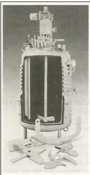
Figura 3. Esquema de un reactor CSTR.
