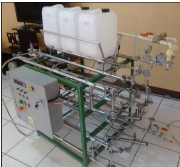
Figura 8. Reactor con tanques instalados
