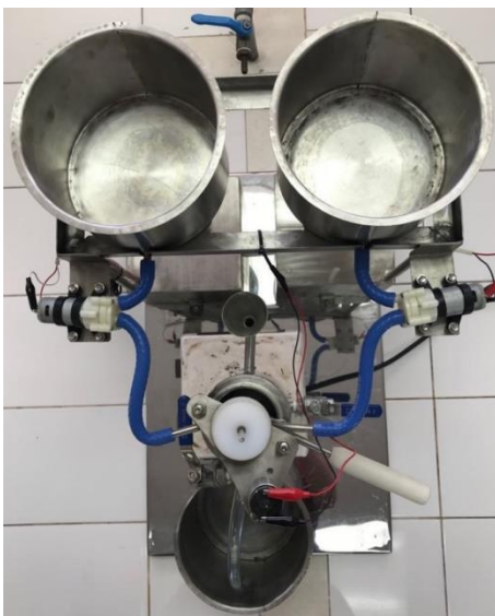
Figura 18. Vista de planta, módulo del reactor
